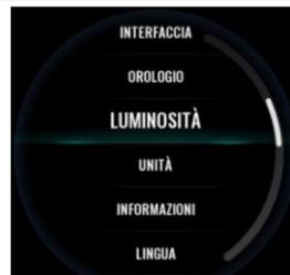
3. Premere brevemente SELECT (selezione) per scegliere tra 5 livelli di luminosità e la AUTOMATICO (in AUTOMATICO, la luminosità della retroilluminazione cambia in base alla luminosità ambientale).
