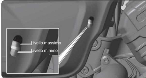
Se il livello del liquido dei freni anteriore o posteriore è inferiore al segno minimo, controllare se ci sono eccessive usure delle pastiglie dei freni o del disco freno, eccessivo gioco del leva del freno, o perdite nel sistema frenante. Portare immediatamente il veicolo in un'officina autorizzata per un controllo e una riparazione.
