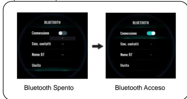
4. Con la connessione Bluetooth attiva e il dispositivo mobile collegato, premere brevemente SELECT (selezione) per scegliere la Sinc. contatti i, poi premere brevemente ENTER (conferma) per sincronizzare i contatti del dispositivo mobile.
